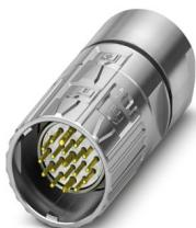
M23, Connettore per cavi, serie: M23 PRO, diritto, schermati: sì, Bloccaggio rapido ONECLICK, Numero di poli: 16+3, Senso di rotazione: standard, tipo di connessione del contatto: Spina, Attacco a saldare, diametro cavi: 3 mm ... 15 mm, codifica: N, L'articolo è senza piombo secondo la direttiva RoHS II senza eccezione 6c (Pb < 0,1 %)
