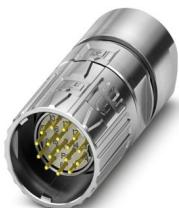
M23, Connnettore per cavi, serie: M23 PRO, diritto, schermati: sì, Bloccaggio rapido ONECLICK, Numero di poli: 17, Senso di rotazione: standard, tipo di connessione del contatto: Spina, Attacco a saldare, diametro cavi: 9 mm ... 15 mm, codifica: N, L'articolo è senza piombo secondo la direttiva RoHS II senza eccezione 6c (Pb < 0,1 %)
