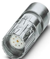
M23, Connnettore per cavi, serie: M23 PRO, diritto, schermati: sì, Bloccaggio rapido ONECLICK, Numero di poli: 8+1, Senso di rotazione: standard, tipo di connessione del contatto: Femmina, Attacco a saldare, diametro cavi: 4 mm ... 8,5 mm, codifica: N, L'articolo è senza piombo secondo la direttiva RoHS II senza eccezione 6c (Pb < 0,1 %)
