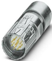
M23, Connettore per cavi, serie: M23 PRO, diritto, schermati: sì, Bloccaggio rapido ONECLICK, Numero di poli: 8+1, Senso di rotazione: standard, tipo di connessione del contatto: Spina, Attacco a saldare, diametro cavi: 4 mm ... 8,5 mm, codifica: N, L'articolo è senza piombo secondo la direttiva RoHS II senza eccezione 6c (Pb < 0,1 %)
