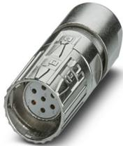
M23, Connettore per cavi, serie: M23 PRO, diritto, schermati: sì, Bloccaggio rapido ONECLICK, Numero di poli: 7, Senso di rotazione: standard, tipo di connessione del contatto: Femmina, Attacco a saldare, diametro cavi: 9 mm ... 15 mm, codifica: N, L'articolo è senza piombo secondo la direttiva RoHS II senza eccezione 6c (Pb < 0,1 %)
