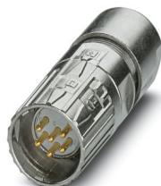
M23, Connettore per cavi, serie: M23 PRO, diritto, schermati: sì, Bloccaggio rapido ONECLICK, Numero di poli: 6, Senso di rotazione: standard, tipo di connessione del contatto: Spina, Attacco a saldare, diametro cavi: 3 mm ... 15 mm, codifica: N, L'articolo è senza piombo secondo la direttiva RoHS II senza eccezione 6c (Pb < 0,1 %)
