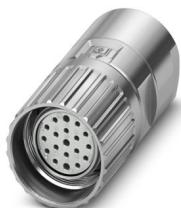
M23, Connnettore per cavi, serie: M23 PRO, diritto, schermati: sì, Bloccaggio a vite, Numero di poli: 16+3, Senso di rotazione: standard, tipo di connessione del contatto: Femmina, Attacco a saldare, diametro cavi: 3 mm ... 15 mm, codifica: N, L'articolo è senza piombo secondo la direttiva RoHS II senza eccezione 6c (Pb < 0,1 %)
