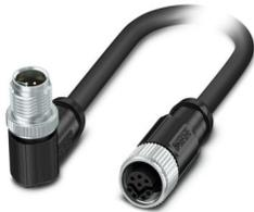
Cavo ibrido, Ethernet ibrido CAT5 (100 MBit/s), 8-poli, PUR senza alogenati, nero RAL 9005, schermata (Advanced Shielding Technology), Maschio angolato M12, codifica: Y / IP65/IP67, su Connettore femmina diritto M12, codifica: Y / IP65/IP67, lunghezza cavo: 2 m, Power with Ethernet (PWE)
