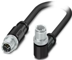
Cavo ibrido, Ethernet ibrido CAT5 (100 MBit/s), 8-poli, PUR senza alogenati, nero RAL 9005, schermata (Advanced Shielding Technology), Maschio diretto M12, codifica: Y / IP65/IP67, su Maschio angolato M12, codifica: Y / IP65/IP67, lunghezza cavo: 30 m, Power with Ethernet (PWE)
