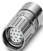
M23, Connnettore per cavi, serie: M23 PRO, diritto, schermati: sì, Bloccaggio a vite, Numero di poli: 12, Senso di rotazione: standard, tipo di connessione del contatto: Femmina, Attacco a saldare, diametro cavi: 3 mm ... 15 mm, codifica: N, L'articolo è senza piombo secondo la direttiva RoHS II senza eccezione 6c (Pb < 0,1 %)
