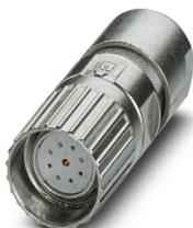
M23, Connettore per cavi, serie: M23 PRO, diritto, schermati: sì, Bloccaggio a vite, Numero di poli: 8+1, Senso di rotazione: standard, tipo di connessione del contatto: Femmina, Attacco a saldare, diametro cavi: 9 mm ... 15 mm, codifica: N, L'articolo è senza piombo secondo la direttiva RoHS II senza eccezione 6c (Pb < 0,1 %)
