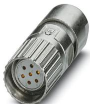
M23, Connettore per cavi, serie: M23 PRO, diritto, schermati: sì, Bloccaggio a vite, Numero di poli: 7, Senso di rotazione: standard, tipo di connessione del contatto: Femmina, Attacco a saldare, diametro cavi: 9 mm ... 15 mm, codifica: N, L'articolo è senza piombo secondo la direttiva RoHS II senza eccezione 6c (Pb < 0,1 %)
