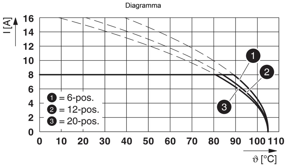
Tipo: DD31PC 2,2/...-3,81-X con DD31H 2,2/...-PT-3,81-X
