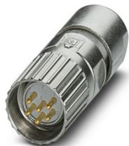
M23, Connettore per cavi, serie: M23 PRO, diritto, schermati: sì, Bloccaggio a vite, Numero di poli: 6, Senso di rotazione: standard, tipo di connessione del contatto: Spina, Attacco a saldare, diametro cavi: 3 mm ... 15 mm, codifica: N, L'articolo è senza piombo secondo la direttiva RoHS II senza eccezione 6c (Pb < 0,1 %)
