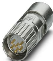
M23, Connettore per cavi, serie: M23 PRO, diritto, schermati: sì, Bloccaggio a vite, Numero di poli: 6, Senso di rotazione: standard, tipo di connessione del contatto: Spina, Attacco a saldare, diametro cavi: 6 mm ... 10 mm, codifica: N, L'articolo è senza piombo secondo la direttiva RoHS II senza eccezione 6c ( $Pb < 0,1\%$ )
