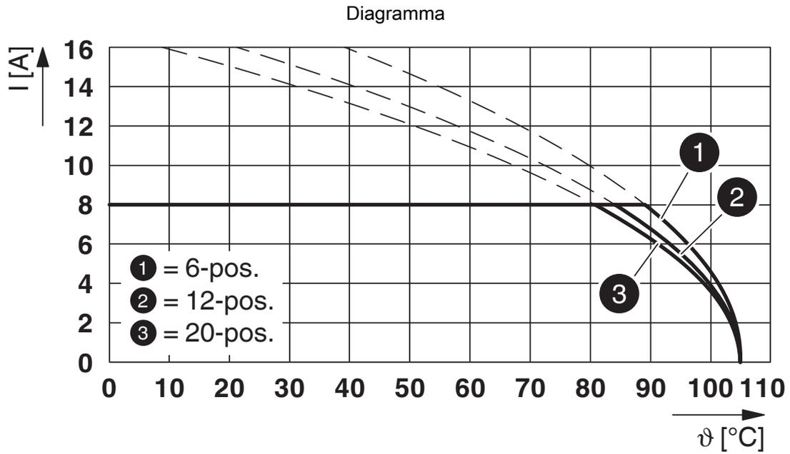
Tipo: DD31PC 2,2/...-3,81-X con DD31H 2,2/...-PT-3,81-X
