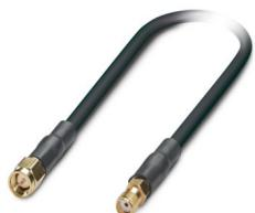
Cavo coassiale 50 Ω, lunghezza: 5 m, SMA(m) - SMA(f), diametro esterno del cavo: 4,9 mm, frequenza di trasmissione: ≤ 7,25 GHz, attenuazione tipica: 800 MHz 2,3 dB, 2,4 GHz 3,8 dB, 5,8 GHz 6 dB, 7,25 GHz 7,3 dB
