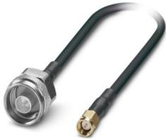
Cavo coassiale 50  $\Omega$ , lunghezza: 5 m, N(m) - SMA(m), diametro esterno del cavo: 4,9 mm, frequenza di trasmissione:  $\leq$  7,25 GHz, attenuazione tipica: 800 MHz 2,3 dB, 2,4 GHz 3,8 dB, 5,8 GHz 6 dB, 7,25 GHz 7,3 dB
