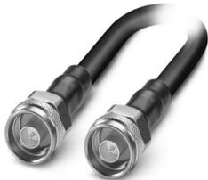
Cavo coassiale 50  $\Omega$ , lunghezza: 10 m, N(m) - N(m), diametro esterno del cavo: 10,3 mm, frequenza di trasmissione:  $\leq 7,25$  GHz, attenuazione tipica: 800 MHz 1,6 dB, 2,4 GHz 2,7 dB, 5,8 GHz 4,3 dB, 7,25 GHz 5 dB
