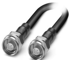
Cavo coassiale 50 Ω, lunghezza: 5 m, N(m) - N(m), diametro esterno del cavo: 10,3 mm, frequenza di trasmissione: ≤ 7,25 GHz, attenuazione tipica: 800 MHz 0,8 dB, 2,4 GHz 1,4 dB, 5,8 GHz 2,2 dB, 7,25 GHz 2,5 dB
