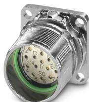
M23, Connettore per apparecchi anteriore, serie: M23 PRO Signal, diritto, schermati: sì, Per il bloccaggio rapido standard e ONECLICK, Numero di poli: 17, Senso di rotazione: standard, tipo di connessione del contatto: Femmina, Attacco a saldare, 4x Ø 3,2, misura flangia: 26 mm x 26 mm, codifica: N, L'articolo è senza piombo secondo la direttiva RoHS II senza eccezione 6c (Pb < 0,1 %)
