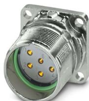
M23, Connettore per apparecchi anteriore, serie: M23 PRO, diritto, schermati: sì, Per il bloccaggio rapido standard e ONECLICK, Numero di poli: 6, Senso di rotazione: standard, tipo di connessione del contatto: Femmina, Attacco a saldare, 4x Ø 2,7 mm, misura flangia: 26 mm x 26 mm, codifica: N, L'articolo è senza piombo secondo la direttiva RoHS II senza eccezione 6c (Pb < 0,1 %)
