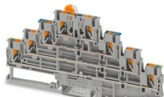
Morsetto per conduttori di terra, Connessione del conduttore di protezione, tipo di connessione: Connessione Push-in, Sezione di dimensionamento: 2,5 mm<sup>2</sup>, sezione: 0,14 mm<sup>2</sup> - 4 mm<sup>2</sup>, Piano passante, tipo di connessione: Connessione Push-in, Sezione di dimensionamento: 2,5 mm<sup>2</sup>, sezione: 0,14 mm<sup>2</sup> - 4 mm<sup>2</sup>, montaggio: NS 35/7,5, NS 35/15, colore: grigio
