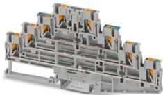
Morsetto per conduttori di terra, numero di connessioni: 8, numero poli: 4, tipo di connessione: Connessione Push-in, Connessione del conduttore di protezione, Sezione di dimensionamento: 2,5 mm<sup>2</sup>, sezione: 0,14 mm<sup>2</sup> - 4 mm<sup>2</sup>, tipo di connessione: Connessione Push-in, Piano passante, Sezione di dimensionamento: 2,5 mm<sup>2</sup>, sezione: 0,14 mm<sup>2</sup> - 4 mm<sup>2</sup>, tipo di montaggio: NS 35/7,5, NS 35/15, colore: grigio
