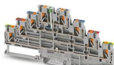
Morsetto a più piani, numero di connessioni: 8, numero poli: 4, tipo di connessione: Connessione Push-in, Connessione del conduttore di protezione, Sezione di dimensionamento: 2,5 mm<sup>2</sup>, sezione: 0,14 mm<sup>2</sup> - 4 mm<sup>2</sup>, tipo di connessione: Connessione Push-in, Piano passante, Sezione di dimensionamento: 2,5 mm<sup>2</sup>, sezione: 0,14 mm<sup>2</sup> - 4 mm<sup>2</sup>, tipo di montaggio: NS 35/7,5, NS 35/15, colore: grigio
