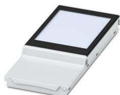
Custodia per guide DIN per l'impiego nei ripartitori di installazione a norma DIN 43880, Coperchio a scatto (fisso), display touch capacitivo da 2,4" integrato, risoluzione: 320 x 240 Pixel, interfaccia: 4-wire SPI, larghezza: 107,6 mm, altezza: 45 mm, profondità: 13,5 mm
