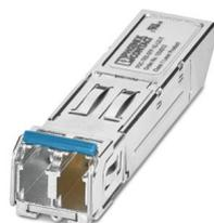
Ricetrasmittitore SFP monomodale per la trasmissione di max. 1 GBit/s su 10 km con lunghezze d'onda di 1310 nm nell'intervallo di temperatura industriale
