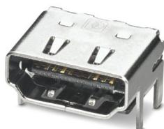
Connettori per circuiti stampati HDMI, tipo: HDMI A, grado di protezione: IP20, numero poli: 19, 14 Gbit/s, materiale: Plastica, tipo di connessione: Attacco a saldare, uscita cavo: diritto
