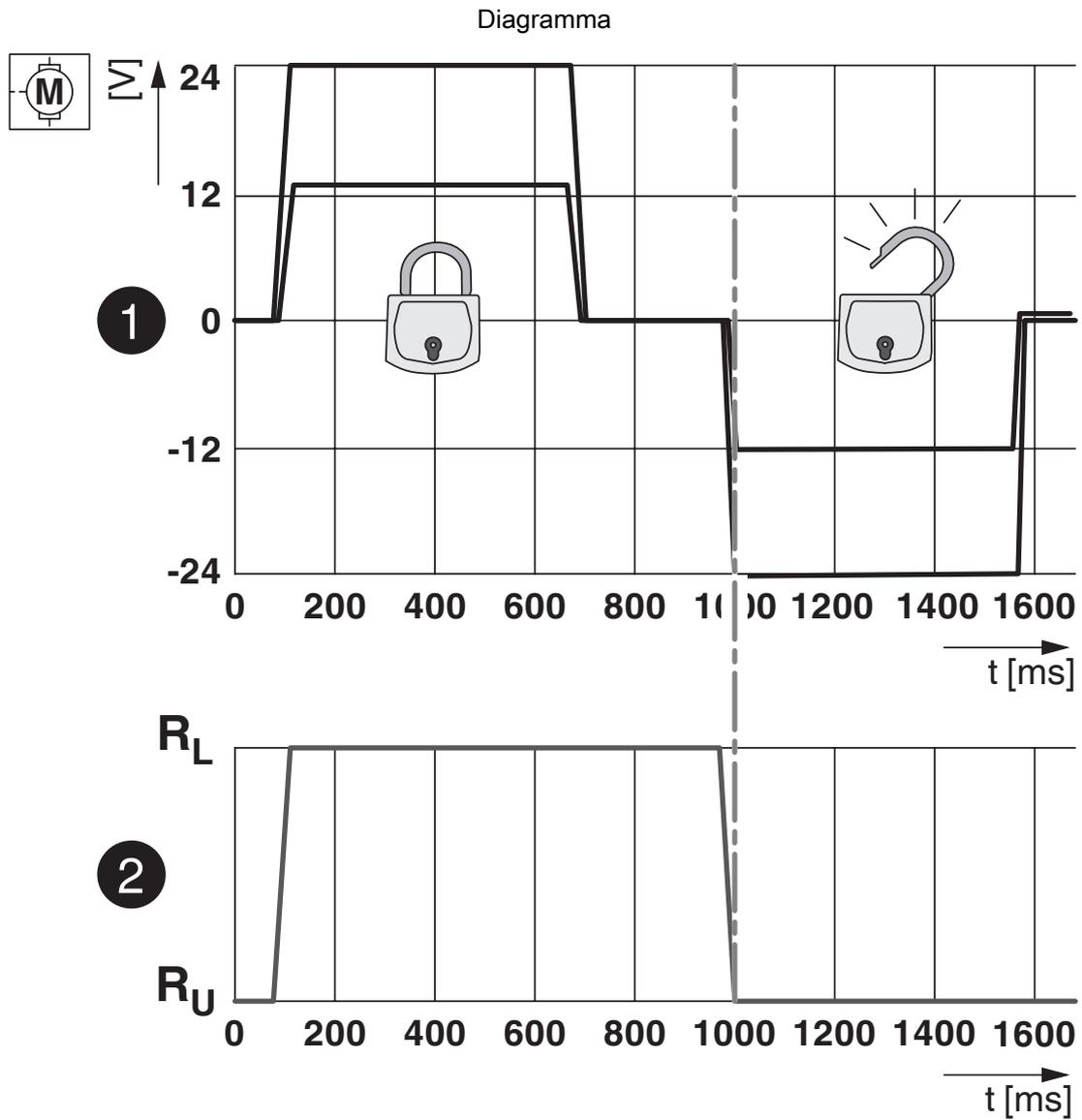
Stati di blocco dell'attuatore di bloccaggio
