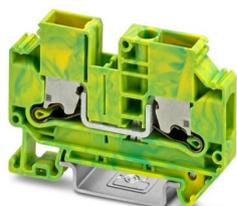
Morsetto per conduttori di terra, numero di connessioni: 2, numero poli: 1, tipo di connessione: Connessione Push-X, Sezione di dimensionamento: 6 mm<sup>2</sup>, sezione: 0,5 mm<sup>2</sup> - 10 mm<sup>2</sup>, tipo di montaggio: NS 35/7,5, NS 35/15, colore: giallo-verde
