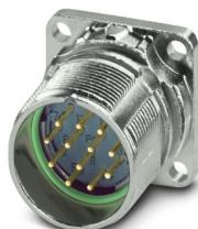
M23, Connettore per apparecchi anteriore, serie: M23 PRO, diritto, schermati: sì, Per il bloccaggio rapido standard e ONECLICK, Numero di poli: 12, Senso di rotazione: Invertito, tipo di connessione del contatto: Spina, Connessione a crimpate, 4x Ø 2,7 mm, misura flangia: 26 mm x 26 mm, codifica: N, L'articolo è senza piombo secondo la direttiva RoHS II senza eccezione 6c (Pb < 0,1 %)
