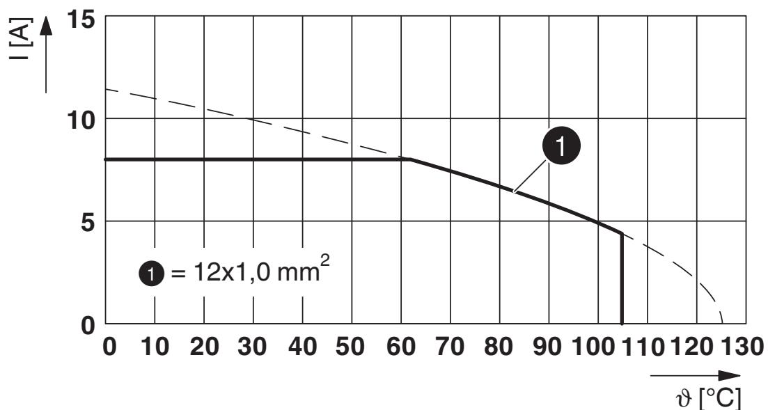
$I$  = intensità di corrente,  $\vartheta$  = temperatura ambiente,  $12 \times 8 \text{ A}$
