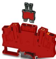
Morsetto sezionatore, tensione nominale: 1000 V, corrente nominale: 32 A, tipo di connessione: Connessione Push-in, Sezione di dimensionamento: 6 mm<sup>2</sup>, sezione: 0,5 mm<sup>2</sup> - 10 mm<sup>2</sup>, montaggio: NS 35/7,5, NS 35/15, NS 32, colore: rosso
