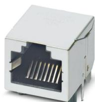
Connettoei per circuiti stampati RJ45, tipo: RJ45, grado di protezione: IP20, numero poli: 8, 10 Gbit/s, materiale: Metallo, tipo di connessione: THR Reflow / THT a onde, Contatti saldati corti
