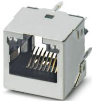
Connettoei per circuiti stampati RJ45, tipo: RJ45, grado di protezione: IP20, numero poli: 8, 10 Gbit/s, materiale: Metallo, tipo di connessione: Attacco a saldare THR, Contatti saldati corti
