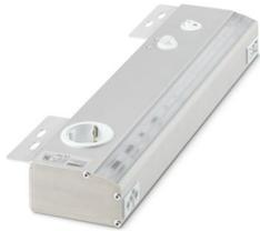
Luce a LED per armadio elettrico, 230 V AC, lunghezza: 395 mm, grado di protezione: IP20, con rilevatore di movimento, Tipo di presa F (Schuko), inclusi accessori di montaggio
