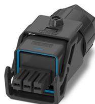
Connettore fotovoltaico (connettore), a 3 poli, trifase, corrente nominale: 35 A, custodia: poliammide, colore custodia: nero, sezione nominale: 4-6 mm<sup>2</sup>, contatto a innesto: rame e leghe di rame
