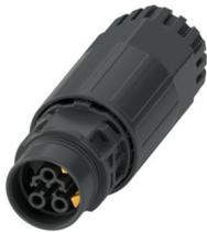
Connettore per giunti, Serie di prodotti: PRC 20, colore: nero, numero poli: 3, sezione del conduttore min.: 0,5 mm<sup>2</sup>, sezione del conduttore max.: 2,5 mm<sup>2</sup>, tensione di dimensionamento: 400 V, corrente nominale: 20 A, Tipo di connessione: Connessione a vite, Tipo di connessione del contatto: Femmina, Possibilità di impostazione per lo sbloccaggio: 1 con un utensile o 2 a mano, campo di applicazione: DC
