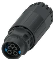
Connettore per giunti, Serie di prodotti: PRC 20, colore: nero, numero poli: 3, sezione del conduttore min.: 0,5 mm<sup>2</sup>, sezione del conduttore max.: 2,5 mm<sup>2</sup>, tensione di dimensionamento: 400 V, corrente nominale: 25 A, Tipo di connessione: Connessione a vite, Tipo di connessione del contatto: Femmina, diametro cavo min.: 8 mm, diametro cavo max.: 14 mm, Possibilità di impostazione per lo sbloccaggio: 1 con un utensile o 2 a mano, campo di applicazione: AC
