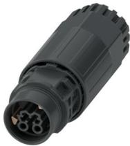
Connettore per giunti, Serie di prodotti: PRC 20, colore: nero, numero poli: 2, sezione del conduttore min.: 0,5 mm<sup>2</sup>, sezione del conduttore max.: 2,5 mm<sup>2</sup>, tensione di dimensionamento: 400 V, corrente nominale: 20 A, Tipo di connessione: Connessione a vite, Tipo di connessione del contatto: Femmina, Possibilità di impostazione per lo sbloccaggio: 1 con un utensile o 2 a mano, campo di applicazione: SELV
