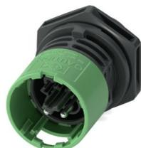
Connettore per apparecchi anteriore, Serie di prodotti: PRC 20, colore: nero, numero poli: 2, sezione del conduttore min.: 0,5 mm<sup>2</sup>, sezione del conduttore max.: 2,5 mm<sup>2</sup>, tensione di dimensionamento: 400 V, corrente nominale: 20 A, Tipo di connessione: Connessione a vite, Tipo di connessione del contatto: Spina, Possibilità di impostazione per lo sbloccaggio: 1 con un utensile o 2 a mano, campo di applicazione: BUS
