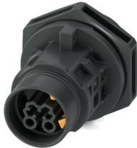
Connettore per apparecchi anteriore, Serie di prodotti: PRC 20, colore: nero, numero poli: 2, sezione del conduttore min.: 0,5 mm<sup>2</sup>, sezione del conduttore max.: 2,5 mm<sup>2</sup>, tensione di dimensionamento: 400 V, corrente nominale: 20 A, Tipo di connessione: Connessione a vite, Tipo di connessione del contatto: Femmina, Possibilità di impostazione per lo sbloccaggio: 1 con un utensile o 2 a mano, campo di applicazione: DC
