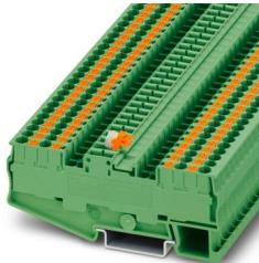
Morsetto con sezionatore a coltello, tensione nominale: 400 V, corrente nominale: 16 A, tipo di connessione: Connessione Push-in, Sezione di dimensionamento: 2,5 mm<sup>2</sup>, sezione: 0,14 mm<sup>2</sup> - 4 mm<sup>2</sup>, montaggio: NS 35/7,5, NS 35/15, colore: verde
