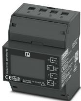
Questo dispositivo è un dispositivo per la misurazione dell'energia trifase digitale, idoneo per misurare la potenza attiva con misurazione diretta in reti elettriche non superiori a 480 V / 100 A, con 2 uscite impulsi, interfaccia RS-485 e range di temperatura di esercizio fino a +70 °C, certificato secondo la direttiva MID.
