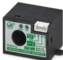
CHARX control modular, il modulo di monitoraggio della corrente differenziale è utilizzato per il rilevamento delle correnti di guasto AC e DC in punti di ricarica a corrente alternata. Il dispositivo di protezione di livello superiore (ad es. l'interruttore differenziale) è protetto da eventuali correnti di guasto DC.
