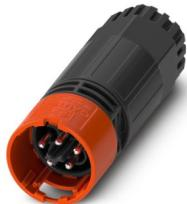
Connettore, Serie di prodotti: PRC 20, colore: nero/rosso, numero poli: 5, sezione del conduttore min.: 0,5 mm<sup>2</sup>, sezione del conduttore max.: 2,5 mm<sup>2</sup>, tensione di dimensionamento: 400 V, corrente nominale: 20 A, Tipo di connessione: Connessione a vite, Tipo di connessione del contatto: Spina, diametro cavo min.: 8 mm, diametro cavo max.: 14 mm, Possibilità di impostazione per lo sbloccaggio: 1 con un utensile o 2 a mano, campo di applicazione: AC
