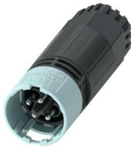
Connettore, Serie di prodotti: PRC 20, colore: nero, numero poli: 4, sezione del conduttore min.: 0,5 mm<sup>2</sup>, sezione del conduttore max.: 2,5 mm<sup>2</sup>, tensione di dimensionamento: 400 V, corrente nominale: 20 A, Tipo di connessione: Connessione a vite, Tipo di connessione del contatto: Spina, Possibilità di impostazione per lo sbloccaggio: 1 con un utensile o 2 a mano, campo di applicazione: SIGNAL
