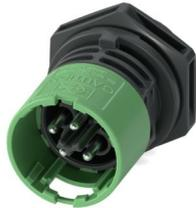
Connettore per apparecchi anteriore, Serie di prodotti: PRC 20, colore: nero, numero poli: 4, sezione del conduttore min.: 0,5 mm<sup>2</sup>, sezione del conduttore max.: 2,5 mm<sup>2</sup>, tensione di dimensionamento: 400 V, corrente nominale: 20 A, Tipo di connessione: Connessione a vite, Tipo di connessione del contatto: Spina, Possibilità di impostazione per lo sbloccaggio: 1 con un utensile o 2 a mano, campo di applicazione: BUS
