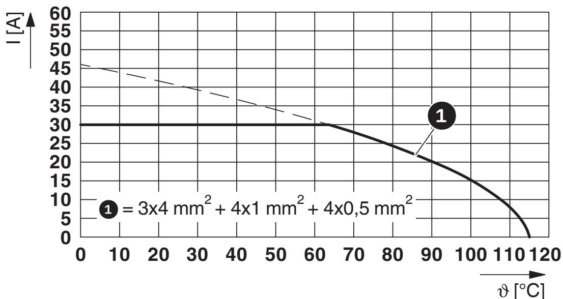
I = intensità di corrente, θ = temperatura ambiente, contatti di potenza A-C: 3 x fino a 30 A, contatti di segnalazione: 4 x 2 A costante, contatti dati: 4 x 1 A costante
