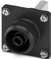
Connettore, Serie di prodotti: BPC, colore: nero, numero poli: 1, sezione del conduttore min.: 95 mm<sup>2</sup>, sezione del conduttore max.: 120 mm<sup>2</sup>, tensione di dimensionamento: 1500, corrente nominale: 350 A, Tipo di connessione: Attacco a vite / a saldare, Tipo di connessione del contatto: Spina
