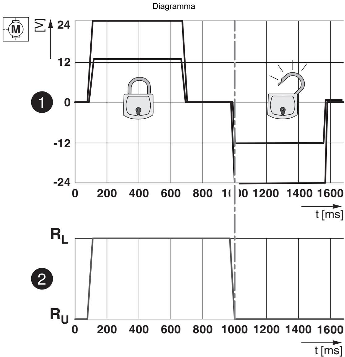
Stati di blocco dell'attuatore di bloccaggio
